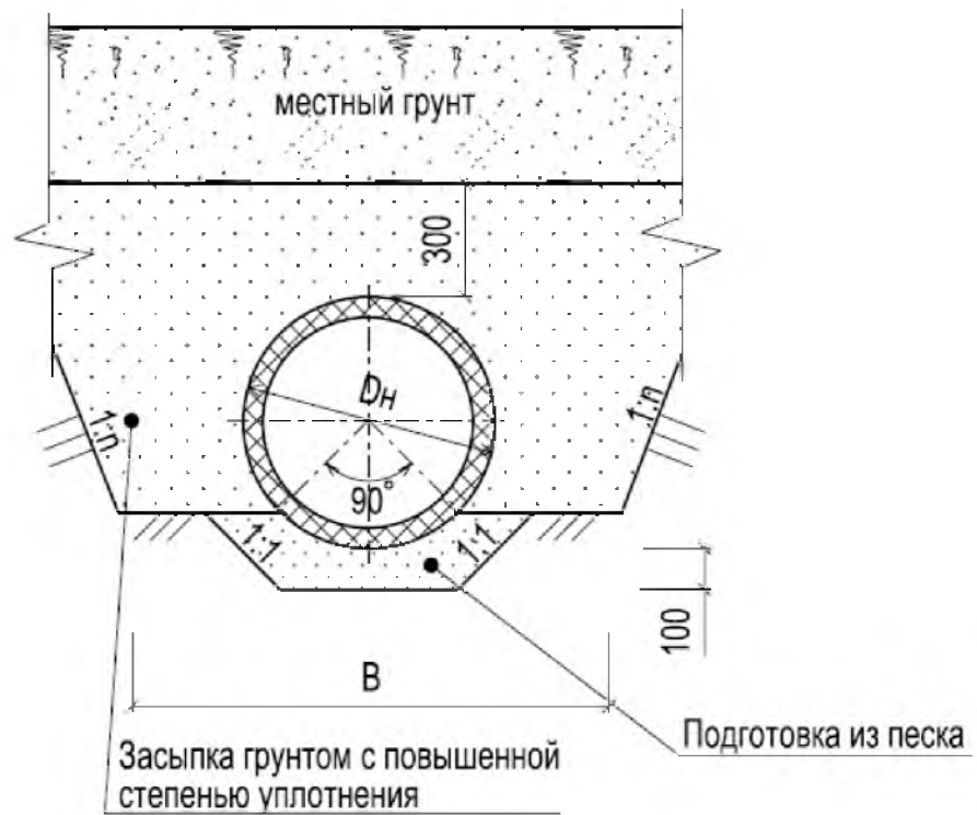
б) Рисунок 9 – Схема укладки труб, грунт основания: глинистые, гравелистые грунты, крупно обломочные скальные породы
